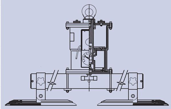
Der BASIC-LIFT erweitert das bewährte AERO-LIFT®-Produktionsprogramm an Vakuumhebergeräten um ein Multitalent. Ohne Vakuumherzeuger oder lästige Stromkabel und somit rein mechanisch ist er völlig unabhängig. Dennoch hebt dieser Typ Lasten von bis zu 1200 kg und mehr.
